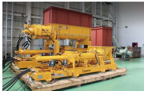
バイオガス発電で活用されているブツマイスターポンプ
