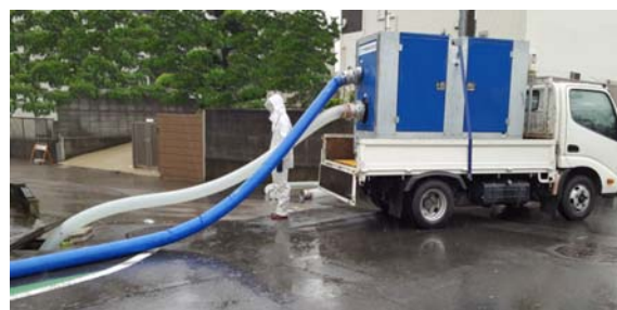
多目的モバイルポンプユニットBETSY (ベツティー) * 写真は、2tトラックの荷台に積載したユニット
